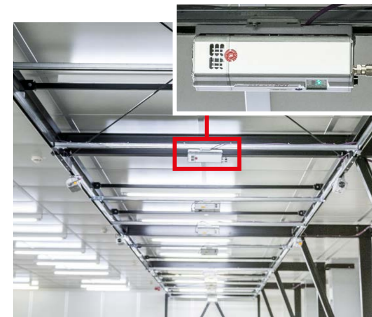
LAP CAD-PRO 激光投影机安装在工作站上方,天花板下方。这款系统配置灵活,大小工具皆宜,工具都是通过移动台送入投影区域。
